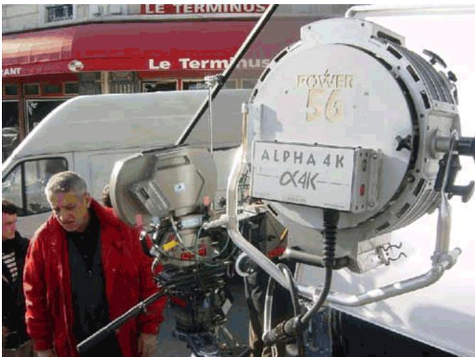
Dispositif avec HMI et diffuseur en extérieur jour
